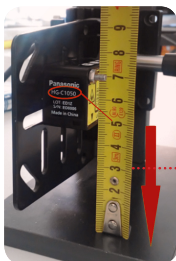
Exemple : HG-C1050-P Hauteur d'installation : 50mm
